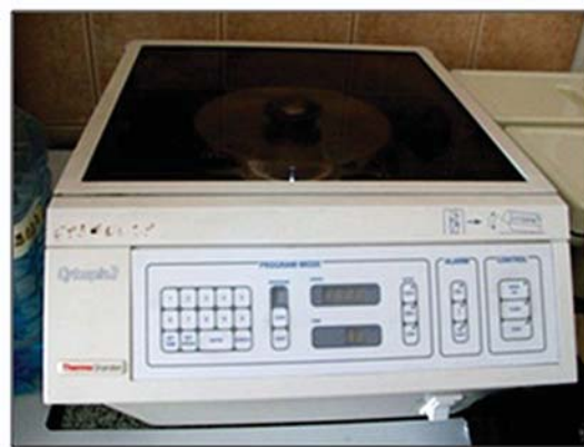
Рис. 1. Цитоцентрифуга Cytospin-3 (Thermo Scientific Shandon, UK)
